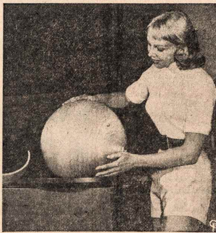
PHILADELPHIJOJE inžinierių parodoje demonstruojamas kamuolys, kuris ir peršautas nesprogdta. Jis skirtas kovos lėktuvam, kuriuose tokie kamuoliai tankai, laika suspaustą orą, peršauti paprastai sprogdta.
