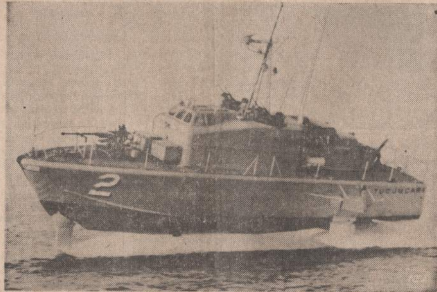
Boeing dirbtuvėse pastatytas šis naujas karo laivas "Tucumcari", turintis 40 milimetrų kanonus, kelis minosvaizdus ir kulkosvaidį. Jis plaukia vandenyje ir gali laikytis vandens paviršiuje. Amerikos karo vadai pirma nori išbandyti, ar jis tiks karo veiksmams jūroje ir pakraščiuose.
