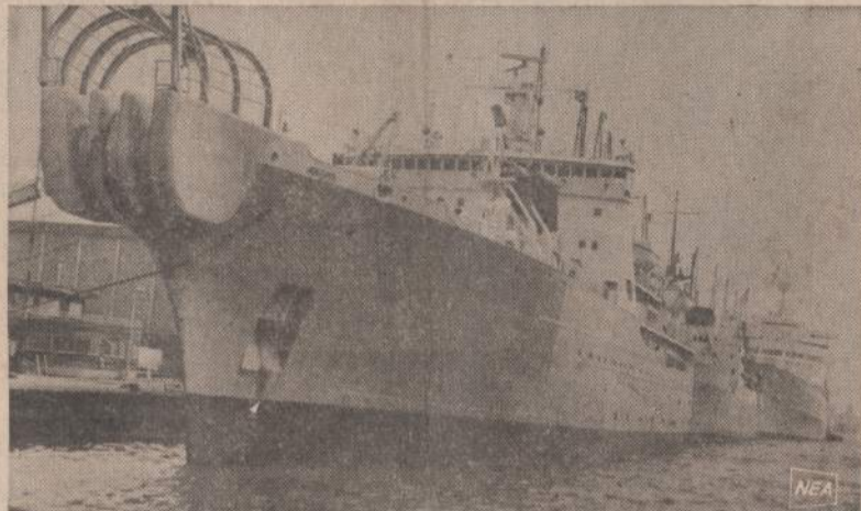
Paveiksle matomas laivas paruoštas povandeninėms telefonų linijoms tiesti. Jis yra paruoštas nutiesti 1,100 mylių ilgio telefono liniją, einančią iš Floridos į Karibų salas. Nutiesta telefono viela vienu ir tuo pačiu metu galės eiti 720 pasikalbėjimų bet kuria kryptimi.
