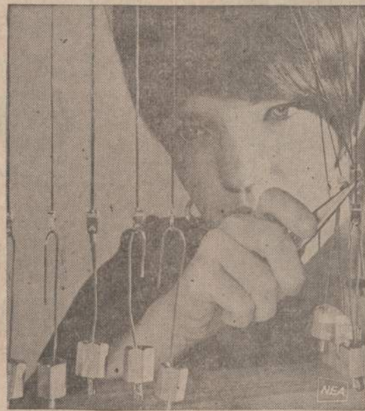
Moters plaukas yra įautriausioji higrometro dalis. Higrometras nustato ir užrašo drėgnumo kiekį. Oro pakaitos labai veikia plaukus. Drėgnumas juos ištempia, o sausra sutraukia. Instrumentams tinka tiksliai tie plaukai, kurie niekad nebuvo dažyti, baltinti arba svielti. Honeywell bendrovės tarnautoja tikrina mašinai parinktus plaukus.
